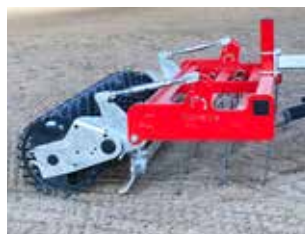
Glätterblech, 3 Reihen Federstahlzinken
